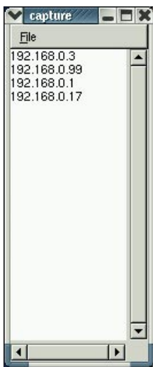
Figura 1: O programa GTK2 capture.pl mostra em uma lista todos os computadores ativos na rede local.
