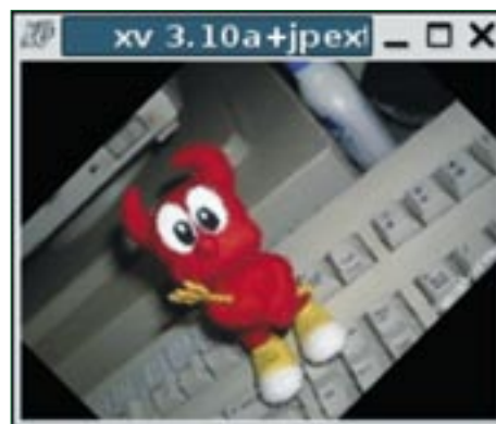
Figura 2 A imagem do pequeno demônio do BSD rotacionada em 45 graus com PIL .
