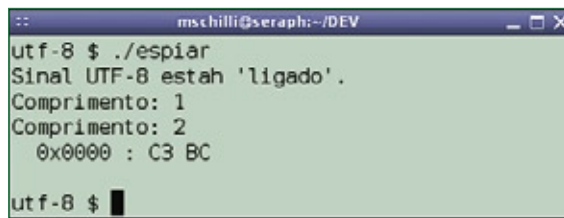
Figura 5 Em uma cadeia Unicode, um caractere multi-byte realmente possui comprimento 1. Se removermos a propriedade Unicode da cadeia, o Perl interpretará os bytes individualmente.
