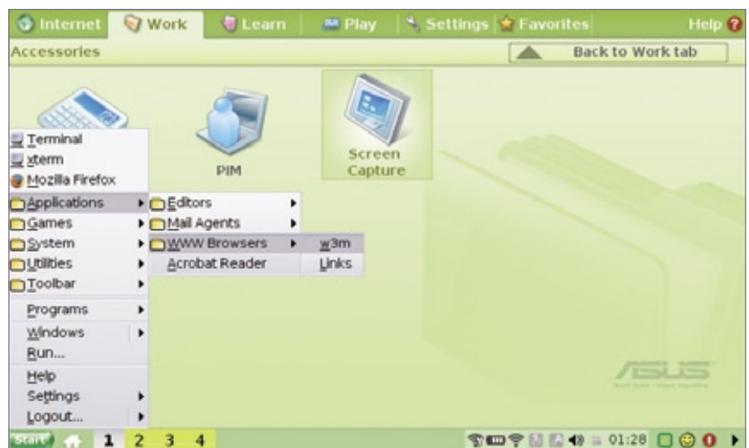
Figura 4 O gerenciador de janelas IceWM permite a conversão do Asus Launcher em um desktop completo com quatro áreas de trabalho e um menu Iniciar .
