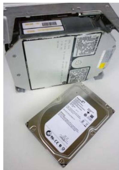
Figura 1 Velho e novo lado a lado: um disco rígido grande no tamanho mas com apenas 85 MB, e um HD SATA 3 TB de última geração da Seagate.
